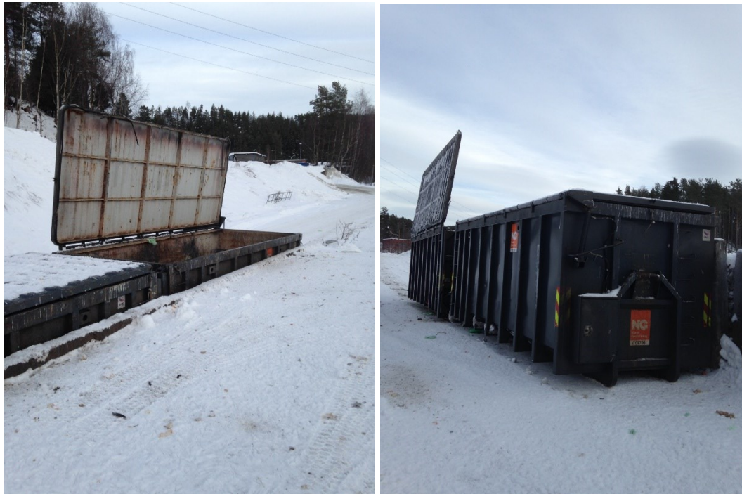
Figur 7 Rampe for omlasting av matavfall. Tette containere med faste lokk.
