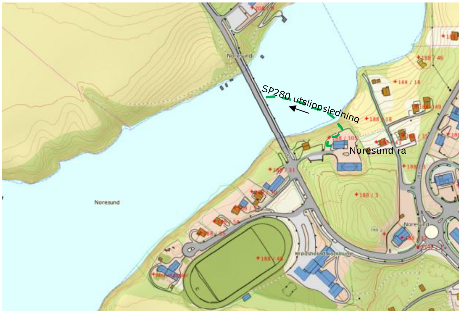
Figur 3. Eksisterende Noresund ra med utslipp til hovedstrøm under Noresund bru.
